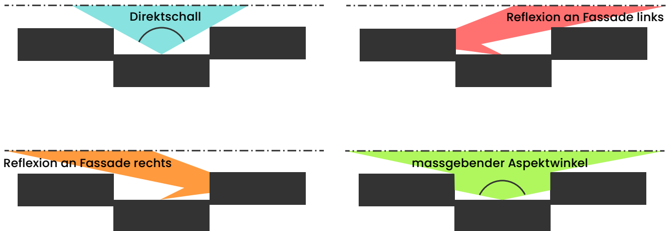
Abb. 10: Bedeutender Reflexionseinfluss an Gebäudeteilen auf derselben Seite wie der Empfangspunkt
