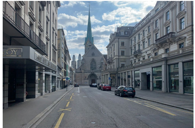
Plastische Fassaden, Vor- und Rücksprünge, Höhenstaffelungen und Elemente wie Stützen oder Balkone streuen den Schall und tragen damit zu einer angenehmen Akustik bei.
